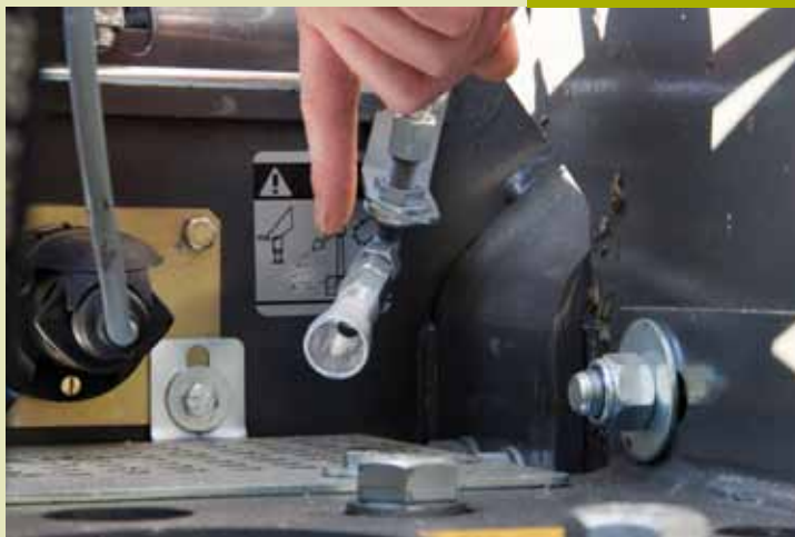
Die aktiven Luftdüsen verhindern Materialablagerungen an der Maschine.
